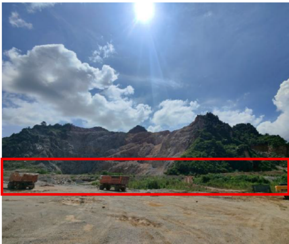
รูปที่ 2-34 (ต่อ) คั่นดักหินขนาดความกว้าง ประมาณ 10 ม. สูง ประมาณ 5 ม.
